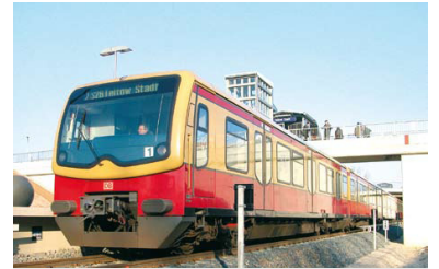
Zug der Baureihe 481 in Teltow Stadt. Ausgerechnet die modernsten Züge der Berliner S-Bahn dürfen aus sicherheitstechnischen Gründen maximal 80 statt 100 km/h fahren, bis die Bremstechnik nachgebessert wurde. Damit sind häufigere Verspätungen auf einigen Linien vorprogrammiert - vor allem auf eingleisigen Abschnitten. (Foto: Marc Heller)
