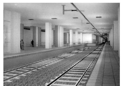
Simulation des geplanten Flughafenbahnhofs unter dem BBI-Terminal. Links der S-Bahnsteig mit Stumpfgleis, rechts einer von zwei Fern- und Regionalverkehrsbahnsteigen. (Grafik: Berliner Flughäfen)
