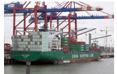
Containerschiff im Hafen Hamburg mit einer Stellplatzkapazität von ca. 2700 TEU. Mittlerweile gibt es noch viel größere, die eine Ladekapazität von über 13 000 TEU haben. Dagegen wirkt dieses hier geradezu mickrig. (Bild: Hafen Hamburg / Bengt van Beuningen)
