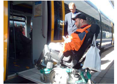
Selten stimmt die Höhe des Fahrzeugs mit dem Bahnsteig überein. Dann sind die Rollstuhlfahrer auf Hilfsmittel oder menschliche Hilfe angewiesen. (Foto: Nord-Ostsee-Bahn GmbH)
