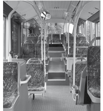
Die BVG schafft Busse an, die nicht mehr 100% niederflurig sind: Der Citaro Low-Entry von Mercedes. Mobilitätseingeschränkte Fahrgäste können die Sitzplätze im Niederflurbereich nutzen, die anderen sitzen im hinteren Hochflurteil in der »Loge«. (Foto: Martin Hawlisch (Wikipedia))
