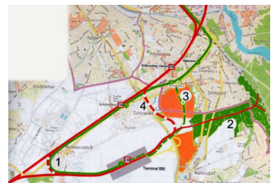
Geplante Trassenführungen und die DBV-Vorschläge (gestrichelte Linien). (1) Kurve Waßmannsdorf-Selchow. Hier fordert der DBV, statt einer zweigleisigen Elektrifizierung für die S-Bahn nur ein Gleis mit Stromschiene auszurüsten und das zweite Gleis mit Oberleitung zu versehen. (2) Ostanbindung durch das Naherholungsgebiet Bohnsdorfer Wald. Die Einfädelung in die Görlitzer Bahn (Strecke Grünauer Kreuz-Königs Wusterhausen) soll gemäß DB-Planung nach Norden und Süden nur eingleisig erfolgen. (3) Der Gegenvorschlag des DBV für die Ostanbindung: S-Bahn-Anbindung ab Grünbergallee mit möglichem neuen Haltepunkt im entstehenden Gewerbegebiet und östlichem Anschluss des Flughafenbahnhofs BBI Terminal. (4) Regional- und Fernzüge werden parallel zur Autobahn zum Außenring geführt und nutzen an der Görlitzer Bahn das Grünauer Kreuz. (Kartengrundlage: Senatsverwaltung für Stadtentwicklung Berlin. Einzeichnung: Heinz-Joachim Bona, Frank Böhnke)
