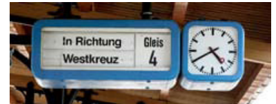
Fallblattzugzielanzeiger auf dem S-Bahnhof Nikolassee. Noch dürftiger, als in Zehlendorf, ist die Fahrgastinformation auf Stationen, auf denen noch leistungsfähige Anzeiger hängen, aber wegen Personaleinsparung nicht bedient werden. (Fotos: Marc Heller (Juli 2008))
