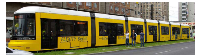
Flexity Berlin auf Präsentationsfahrt am Alex. Das Interesse der Fahrgäste war sehr groß. Dieses 40 Meter lange Einrichtungsfahrzeug bietet 84 Sitz- und 164 Stehplätze. Die Fahrzeugserie gibt es mit 7 oder 5 Modulen (30,8 m), je als Ein- oder Zweirichter. (Foto: Thomas Billik)
