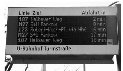
Das für die Fahrgäste sichtbarste Zeichen des Rechnergestützten Betriebs-Leitsystems (RBL) beim BVGBusverkehr sind die »Daisy-Anzeiger« an den Haltestellen. (Foto: Florian Müller)
