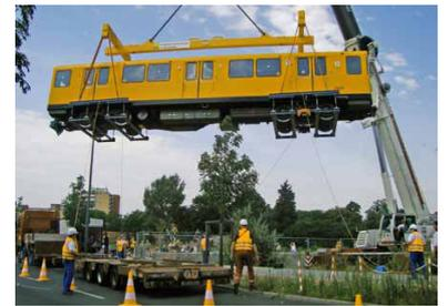
Die acht Fahrzeuge gelangten per Kran durch die Materialeinlassöffnung in den Tunnel, denn einen Gleisanschluss zum U-Bahn-Netz hat die U 55 nicht.
