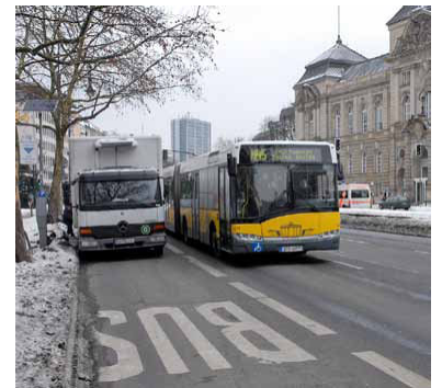
Blockierte Busspur in der Hardenbergstraße. Durch die Anordnung in Seitenlage werden die Busspuren regelmäßig als Ladespuren missbraucht. Abhilfe brächte eine Verlagerung auf die zweite Spur, wie beim Kurfürstendamm erfolgreich praktiziert. (Foto: Marc Heller)
