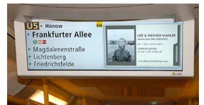
Rechts läuft weiterhin das »Berliner Fenster«, die linke Hälfte dient nun der Fahrgastinformation. Neben der aktuellen werden auch die folgenden Haltestellen aufgelistet. (Foto: Marc Heller)
