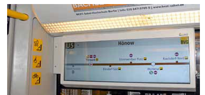
Neue LED-Anzeige an den Frontseiten des Zuges: Ziel und Liniennummer in Farbe sind gut lesbar. (Fotos: Marc Heller)
