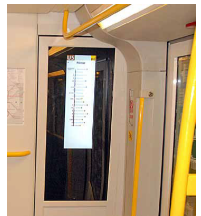
Komplette Perlschnur an der Fahrerraumrückwand. Aktuelle Station und Fahrtrichtung werden mit einem kleinen Pfeil angezeigt. Die bereits abgefahrenen Stationen sind ausgegraut, die folgenden in der Linienkennfarbe dargestellt. (Foto: Marc Heller)
