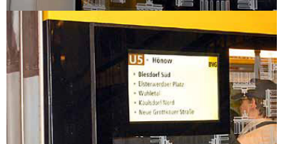
Je rechts vom Faltenbalg zeigt der Monitor innen einen vergrößerten Ausschnitt der Perlschnur mit aktuellem Standort an. Außen werden Linie, Ziel und die nächsten Haltestellen analog zum »Berliner Fenster« angezeigt. (Fotos: Marc Heller)
