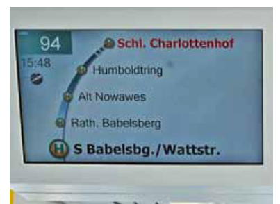
Deutlich ausgereifter ist die Darstellung in Potsdam beim VIP - durch die perspektivische
