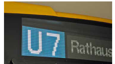
Neue LED-Anzeiger an den Frontseiten des Zuges: Ziel und Liniennummer in Farbe sind gut lesbar. (Fotos: Marc Heller)
