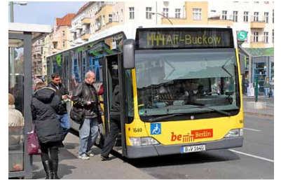
Durch das seitliche Absenken des Busses (Kneeling) wird den BVG-Fahrgästen der Einstieg erleichtert. Das soll, um Kosten zu sparen, künftig nicht mehr automatisch erfolgen, sondern nur noch »bei Bedarf«. (Foto: Marc Heller)
