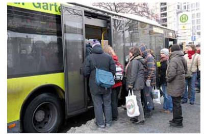
An stark frequentierten Haltestellen wie hier auf dem Hardenbergplatz am Bahnhof Zoo können oder wollen die Busfahrer den Zwang zum »Vorneinstieg« nicht mehr durchsetzen und dulden den Zustieg auch an den hinteren Türen. Dadurch lassen sich der Haltestellenaufenthalt verkürzen und die Verteilung der Fahrgäste im Fahrzeug verbessern, insbesondere bei Gelenkbussen. (Foto: Marc Heller)
