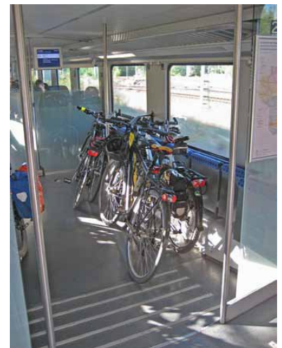
Mehrzweckabteil in jedem Doppelstockwagen der DB Regio in Brandenburg: eine gute Lösung für Linien mit hoher Nachfrage in der Hauptverkehrszeit einerseits und fahrradtouristischer Relevanz andererseits. (Foto: Martina Löbe)
