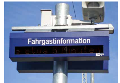
Solche »dynamischen Schriftanzeiger« (DSA) sollen auf einigen S-Bahnhöfen an Außenstrecken die Fahrgäste im Störfall mit einer Laufschrift informieren. Bei der Regionalbahn sind bereits einige in Betrieb, so wie hier im Bahnhof Britz bei Eberswalde mit dem Hinweis auf 5 Minuten Verspätung, die zusätzlich per Lautsprecher angesagt wird. (Foto: Florian Müller)
