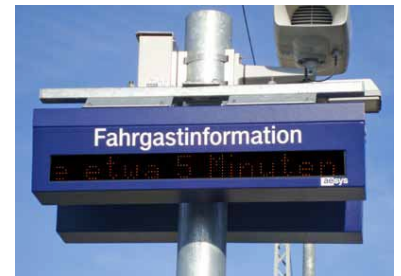
Solche „dynamischen Schriftdanzeiger“ (DSA) sollen auf einigen S-Bahnhöfen an Außenstrecken die Fahrgäste im Störfall mit einer Laufschrift informieren. Bei der Regionalbahn sind bereits einige in Betrieb, so wie hier im Bahnhof Britz bei Eberswalde mit dem Hinweis auf 5 Minuten Verspätung, die zusätzlich per Lautsprecher angesagt wird. (Foto: Florian Müller)
