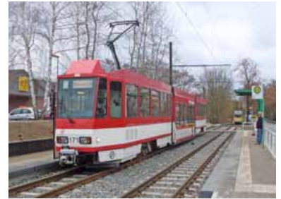
Aus Cottbus nach Schöneiche bei Berlin: Der KTNF6, eine Straßenbahn vom Typ Tatra mit nachträglich hinzugefügtem Niederflurmittelteil, steht während einer Präsentationsfahrt am Torellplatz. (Foto: Tom Gerlich)
