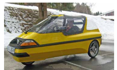
Der CityEL, ein in Deutschland produziertes Serienfahrzeug. Von diesem einsitzigen Elektrofahrzeug wurden bisher rund 6000 Exemplare verkauft. (Foto: Lydia Gaber)
