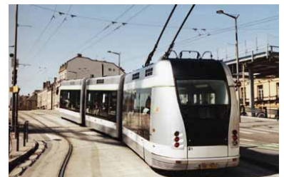
Recht störungsanfälliger Betrieb: Straßenbahn auf Gummirädern und mit Führungsschiene in Nancy in Lothringen. Besser wäre es, das System zu einer »richtigen« Straßenbahn auszubauen und mit dem regionalen Eisenbahnnetz zu verknüpfen. (Foto: Martin Schiefelbusch)
