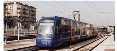
Straßenbahn auf Staatsbahngleisen im Bahnhof Bondy bei Paris. Das »Karlsruher Modell« bewährt sich auch in Frankreich. So lässt sich das Angebot auf vielen Bahnstrecken deutlich verbessern. Nicht zuletzt ermöglichen solche »Tram-Train«-Systeme, einige seit langem stillgelegte Strecken für den Personenverkehr zu reaktivieren. (Foto: Martin Schiefelbusch)
