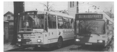
Für die offizielle Abschiedsfahrt setzte der VpP den Wagen 976 ein (links, Marke Skoda), der erst 1994 für 90.000 DM aufgearbeitet worden war. Nach der nun erfolgten Außerdienststellung aller O-Busse der Marke Skoda stehen dem Verkehrsbetrieb nur noch die beiden Duo-Busse, Marke Daimler Benz, zu Verfügung (rechts), die 1993 nach der Unterbrechung der Oberleitung am Bf Drewitz beschafft wurden. (Foto: Marc Heller)
