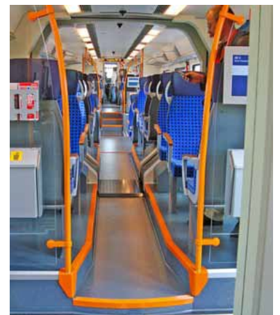
Die untere Verengung des Wagenüberganges über dem Jakobsdrehgestell fällt kaum auf. (Foto: F. Müller)
