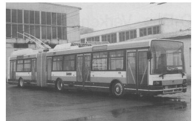
Beide haben an der ersten und zweiten Tür einen Niederflureinstieg und sind auch mit Hilfsmotor für Strecken ohne Oberleitung lieferbar. (Foto: Ivo Köhler)
