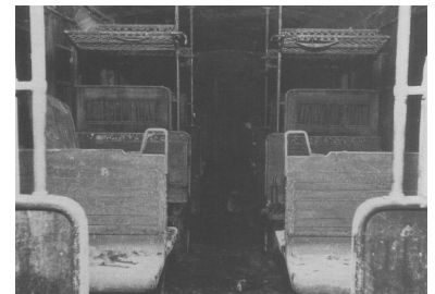
So sahen die im Nord-Süd-S-Bahn-Tunnel abgestellten S-Bahn-Züge nach der wahnwitzigen Tunnelflutung unmittelbar vor Kriegsende aus. Erst nach umfangreichen Reparaturen waren diese Fahrzeuge wieder einsatzfähig. (Foto: LaBi)
