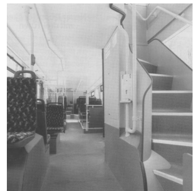
Der neue Doppeldecker weist im Unterdeck eine geräumige Gestaltung mit ebenem Wagenboden im vorderen und vergleichsweise niedrigen Podesten im hinteren Wagenteil auf. Auf dem ansteigenden Weg nach hinten werden sich etwas größere Fahrgäste allerdings (zumindest anfangs) ab und zu den Kopf stoßen. Im Unterdeck gibt es 25 und im Oberdeck 46 Sitzplätze. Zusammen mit den 23 Stehplätzen im Unterdeck ist der Bus für 94 Fahrgäste zugelassen. (Foto: MAN Nutzfahrzeuge AG)
