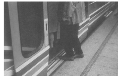
Paris: Bei der 1992 in Paris in Betrieb genommenen neuen Straßenbahn entstehen solche Probleme erst gar nicht: Bahnsteigkante und Fahrzeugstufe liegen genau auf einer Höhe, und die Lücke ist auf 2 cm reduziert - Rollstuhlfahrer können ohne Lift und fremde Hilfe in das Niederflurfahrzeug rollen. (Foto: Matthias Horth)
