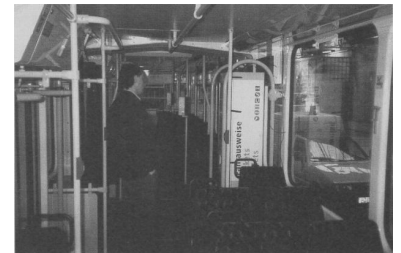
Insbesondere im Türbereich sind die neuen Niederflurzüge mit Sitzplätzen "zugebaut". Umso erstaunlicher ist, daß sie trotzdem einen unerreicht niedrigen Sitzplatzanteil haben. 58 Sitzplätze in einem 27-m-Zug unterbietet derzeit kein Hersteller. (Foto: Frank Brunner)
