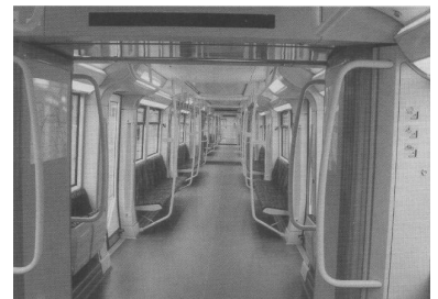
Besonders bemerkenswert ist, daß die der Baureihe H einen durchgehenden Fahrgastraum haben. Durch die ausschließliche Längsanordnung der Sitze wirkt der Zug innen breiter und verspricht eine Reduzierung des Angstgefühls in der abendlichen U-Bahn. Die Kehrseite ist ein reduziertes Sitzplatzangebot, weshalb der Berliner Fahrgastverband IGEB anregt, die vier mittleren, für den Fahrgastfluß weniger bedeutsamen Wagen mit Quersitzen auszustatten. (Foto: Marc Heller)
