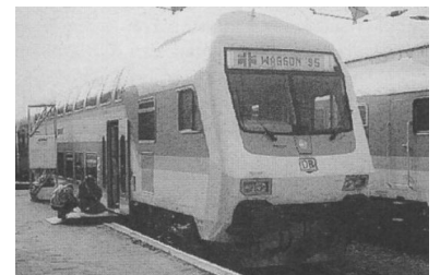
Doppelstock-Steuerwagen - positiv: Niederflureinsteige auch mit Rollstuhlrampe (Foto: I. Köhler)
