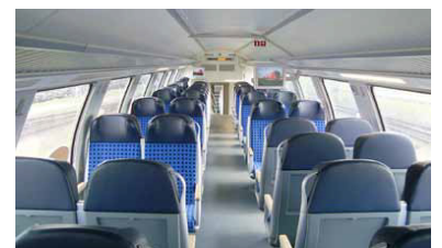
Es herrscht weiterhin ein Angebot von Vis-à-vis-Bestuhlung und Reihenbestuhlung vor. Die Fahrgastinfo ist mit LED-Anzeigern über der Treppe und TFT-Monitoren nicht deutlich weiterentwickelt worden. (Foto: Florian Müller)
