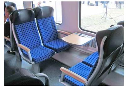
Neue Polster, weichere Sitze und Tischchen an jedem Vis-à-vis-Sitz, aber auch 2 cm weniger Kniefreiheit: Die neue Einrichtung der sanierten Doppelstockwagen. Steckdosen befinden sich an jedem Doppelsitz. (Foto: Florian Müller)
