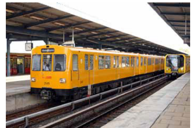
U-Bahnhof Wuhletal mit Großprofilzügen der alten Baureihe F (links) und der neuen Baureihe H. Die aus den 1970er Jahren stammenden 91 Doppeltriebwagen (Baureihen F74, F76 und F79) sollen bis 2019 ertüchtigt werden und dann für weitere 20 Jahre im Fahrgastverkehr sein. (Foto: Marc Heller)
