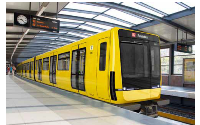
So soll der neue U-Bahn-Kleinprofilzug der Baureihe IK aussehen. Der Auftragnehmer Stadler Pankow GmbH soll bis 2015 zunächst zwei Vorserienfahrzeuge liefern. Nach umfangreichem Test sollen anschließend 24 weitere Fahrzeuge bestellt und ab Dezember 2017 ausgeliefert werden und die Altbaufahrzeuge der Baureihe A3L71 ersetzen. (Zeichnung: Stadler/büro+staubach)
