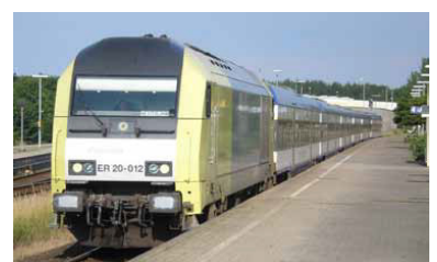
Bahnhof Husum an der Bahnstrecke Hamburg--Westerland. Diese Strecke ist lediglich bis Itzehoe elektrifiziert. Zur Vermeidung von Umspannaufhalten werden die Züge der Nord-Ostsee-Bahn auf der Gesamtstrecke mit Dieselloks befördert. (Foto: Christian Schultz)
