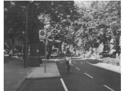
Vorbildlich: Auf den Südwestkorso gibt es einen Fahrradstreifen und ein Haltestellenkap. Doch entgegen der Koalitionsvereinbarung von SPD und AL sollen solche Lösungen nach dem Willen der Verkehrsverwaltung die Ausnahme bleiben. Noch immer plant man dort neue Radwege zulasten der Gehwege. (Foto: M. Horth)
