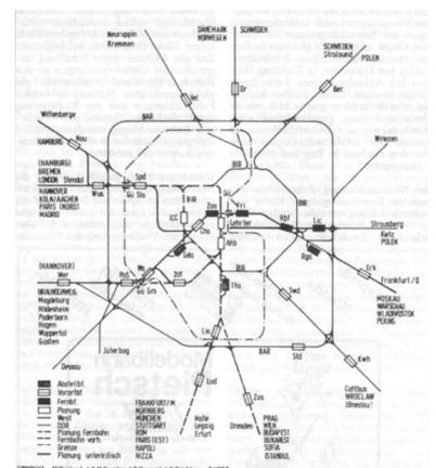
Abb. 4: Die Lage des unterirdischen Fernbahngleisdreiecks im Herz der 11 (bzw. 13)-strahligen Fernbahngeometrie Berlins.
