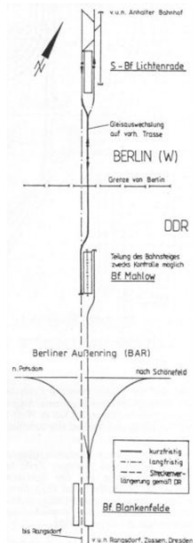
5,7 km lang ist die Strecke von Lichtenrade bis Blankenfelde. 1,2 km davon liegen in West-Berlin. Die Rodungsarbeiten haben bereits begonnen. Ab Mai 1990 sollen die Erdarbeiten folgen, und Ende 1991 könnten die ersten S-Bahn-Züge wieder fahren. (Zeichnung: SenArbVuB III)
