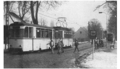
Ein sogenannter Reko-Zug an der Dorfaue in Schöneiche. Diese Fahrzeuge verschleifen die Schienen und sollten möglichst schnell ersetzt werden. (Foto: I. Köhler)
