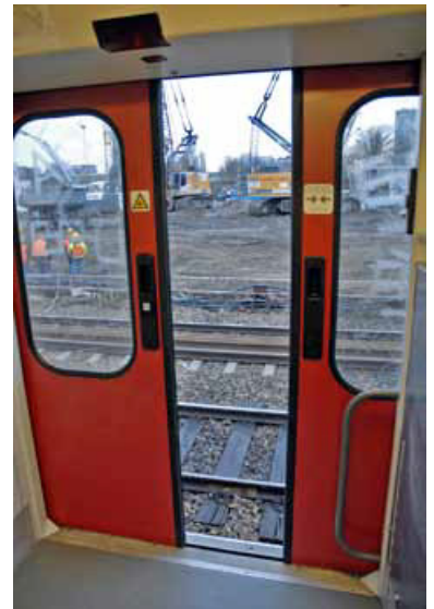
Zug der Baureihe 485 im S-Bahnhof Ostkreuz. Bisher ist es zeitweise möglich, während des Kehrens am Bahnsteig die Türen auf der dem Bahnsteig abgewandten Seite zu öffnen. Deshalb wird 2012/2013 die Türsteuerung bei allen 80 Viertelzügen dieser Baureihe umgebaut. (Foto: Marc Heller)
