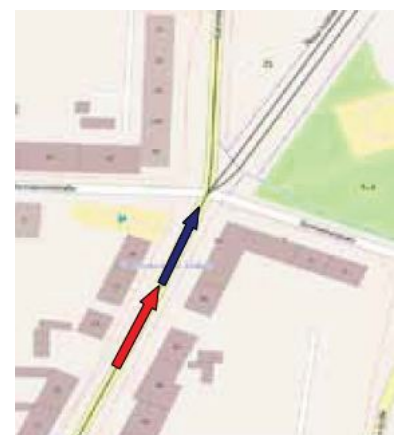
Phase 3: Die 1 fährt auf dem Gleis Richtung TKC bis über den Wechsler, dann stadteinwärts und wartet vor der Kreuzung auf die 4. (Zeichnung: Pro Tram Cottbus)
