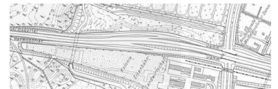
Im Norden von Berlin-Tegel wurde die Autobahn auf die Kremmener Bahn gebaut. Zwischen dem Hermsdofer und dem Waidmannsluster Damm müssen deshalb jetzt einige Kleingärten beseitigt werden, um die S-S-Bahn-Strecke zwischen Tegel und Schulzendorf wiederherstellen zu können. Die betroffenen Kleingärten liegen allerdings alle auf Bahngelände. (Karte: SenBauWohn V)
