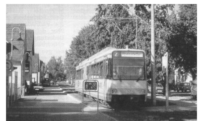
Die Neubaustrecke in Karlsruhe-Forchheim, ein gelungenes Beispiel für Straßengestaltung mit Straßenbahn. Und wo es eng wird, kann solch eine Strecke - bei durchdachter Fahrplangestaltung - auf kurzen Abschnitten problemlos eingeleigt bleiben. (Foto: M. Horth)
