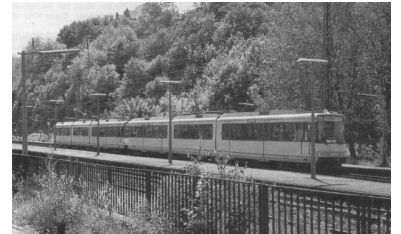
Neuer Mehrsystem-Stadtbahnwagen auf der Fahrt von Karlsruhe nach Pforzheim im Bf. Grötzingen. Die städtischen Verkehrsbetriebe in Karlsruhe können mit ihrer Straßenbahn jetzt auch auf elektrifizierten Fernbahnstrecken der Deutschen Bundesbahn fahren. (Foto: U. Schulz)
