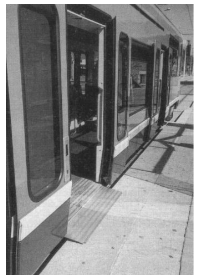
Die Niederflurwagen in Grenoble ermöglicht einen ebenerdigen und lückenlosen Einstieg, von dem nicht nur Rollstuhlfahrer, die ohne fremde Hilfe das Fahrzeug nutzen können, sondern auch alle anderen Fahrgäste profitieren. (Foto: M. Horth)
