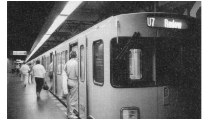
U-Bahn-Wagen der neuen Serie F90, die seit September im Fahrgastbetrieb eingesetzt werden. Die Fenster in der Tür zum Fahrerraum ermöglichen einen Durchblick von einem Doppeltriebwagen in den nächsten. Dies dient dem Sicherheitsgefühl der Fahrgäste. Die IGEB fordert deshalb, daß in allen älteren F-Wagen die vorhandenen Türen gegen neue mit Fenster ausgetauscht werden. (Foto: Th. Billik)
