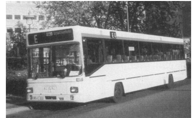
Privatbus im Schienenerstzverkehr der BVG. Das Fahrzeug ist für die Berliner Fahrgäste nur schlecht erkennbar, u.a. wegen der weißen Farbe und der unvollständigen, aufgrund des Tram-Symbols auch noch irritierenden Zielanzeige. (Foto: M. Horth)
