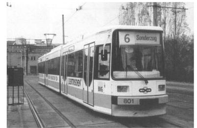
Sechssachsiger Niederflur-Gelenktriebwagen, ab 1995 im fahrplanmäßigen Einsatz auf der Linie 4, 29 dieser Wagen sind jetzt endlich bei der AEG bestellt worden, 91 sollen folgen. Aber die Zahl der neuen Fahrzeuge erreicht nicht annähernd den Umfang, der zum Einsatz für ausgemusterte Straßenbahnen und für den Betrieb neuer Strecken erforderlich ist. (Foto: Frank Brunner)
