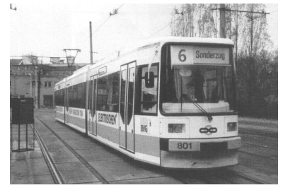
Sechssachsiger Niederflur-Gelenktriebwagen, ab 1995 im fahrplanmäßigen Einsatz auf der Linie 4, 29 dieser Wagen sind jetzt endlich bei der AEG bestellt worden, 91 sollen folgen. Aber die Zahl der neuen Fahrzeuge erreicht nicht annähernd den Umfang, der zum Einsatz für ausgemusterte Straßenbahnen und für den Betrieb neuer Strecken erforderlich ist. (Foto: Frank Brunner)
