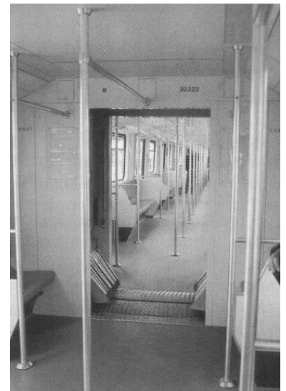
Blick durch den Zug, oben der BVG-Versuchszug, hier ein U-Bahn-Zug für Shanghai. Der Übergang zwischen den beiden Wagen ist beim BVG-Zug nicht nur deutlich großzügiger gestaltet, sondern er ist auch für seh- und für gehbehinderte Fahrgäste sehr viel sicherer. (Foto: Thomas Billik)
