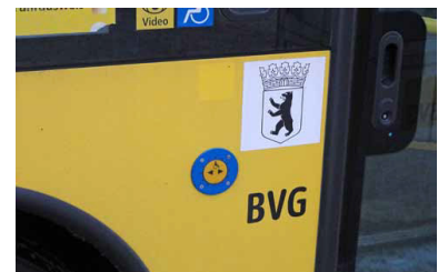
Soll sich der Bus beim Einstieg absenken, muss diese extra neu eingebaute Taste links neben der ersten Tür gedrückt werden. Der Fahrer soll dann eigentlich den Bus absenken. Jedoch leuchtet beim Fahrer lediglich eine Lampe auf dem Armaturenbrett auf ... (Foto: Holger Mertens)
