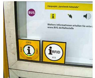
Drückt der Fahrgast auf die leuchtende Taste oder hält ein Proband eine besondere RFID-Karte in die Nähe, wird der DAISY-Anzeiger Zeile für Zeile laut vorgelesen. Der Aushang hinter der Taste gibt einen kurzen Hinweis auf die »Sprechende Haltestelle«. (Foto: Florian Müller)
