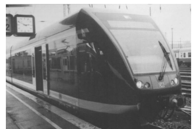
Außenansicht der BR 646/946. Am linken Bildrand ist das Motorteil zu erkennen. (Foto: Kai-Uwe Thiessenhusen)
