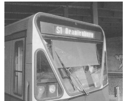
Die Zugzielanzeiger der Baureihe 480 wurden für viel Geld umgerüstet. Nur die Programmierung bereitet Schwierigkeiten - so haben die Fahrgäste nicht viel davon. (Foto: Florian Müller, August 2001)
