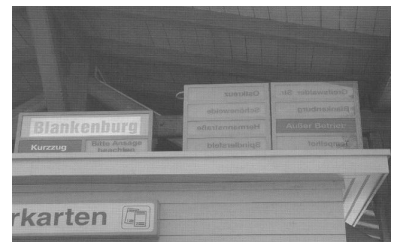
Auf den Bahnhof Oberspree wird versuchsweise ein aus einem Zug ausgebauter Rollband-Zugzielanzeiger eingesetzt. Die Schriftscheiben im Leuchtkasten wurden einfach umgedreht. (Foto: Florian Müller, August 2001)
